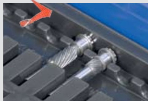
Diepgetrokken inzetstuk met exacte positionering van de assen
